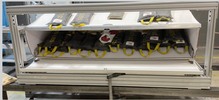
E175 bin inertial load test
